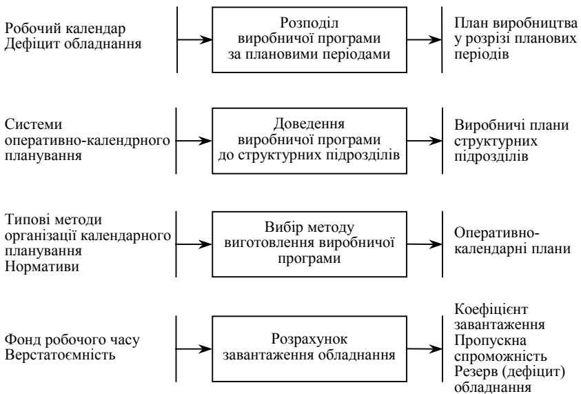
Рис. 1. Технологічна схема планування виконання виробничої програми
