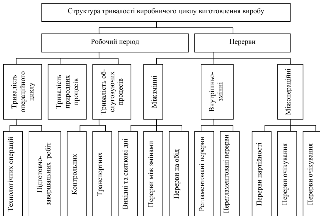
Рис. 1. Структура тривалості виробничого циклу виготовлення виробу
