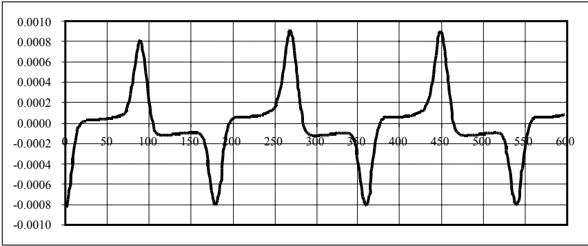
Рис. 5. Періодичні гауссові імпульси впливу \varphi(t) на осцилятор Тоди
