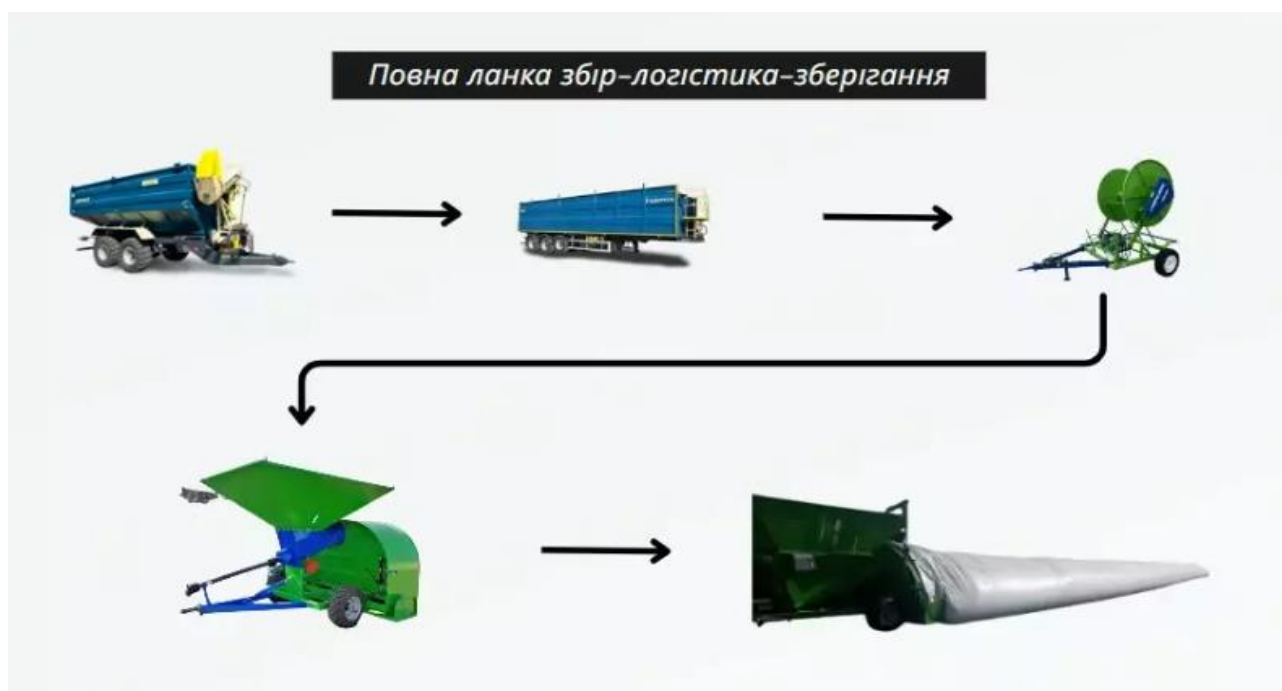
Рисунок 2.13 – Схема процесу наповнення зерна для зберігання у мобільному зерновому рукаві
