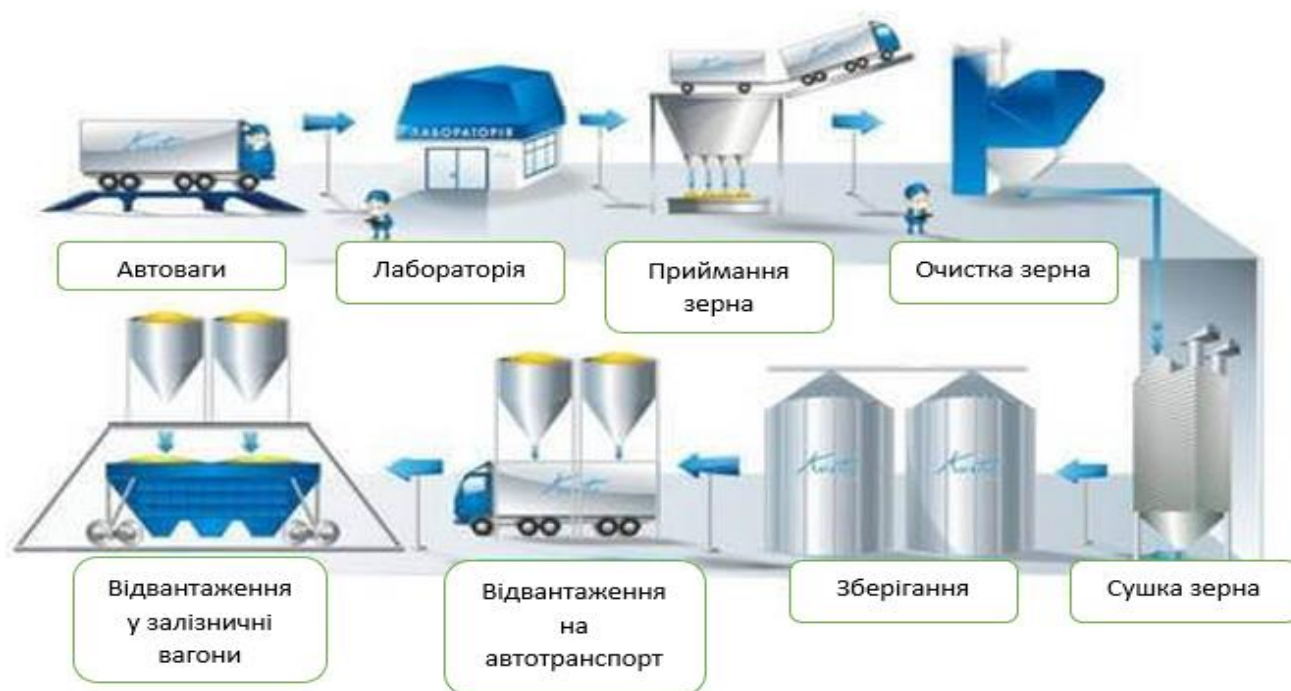
Рисунок 2.6 – Загальна схема технологічного процесу роботи елеватора
