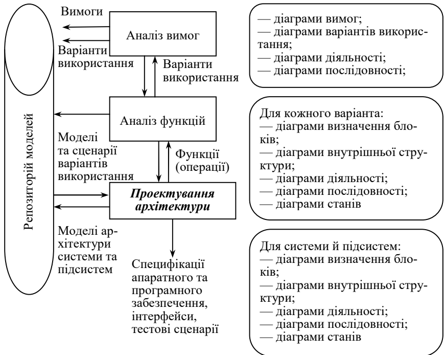
Рис. 8.2. Процес розробки систем, оснований на використанні SysML
