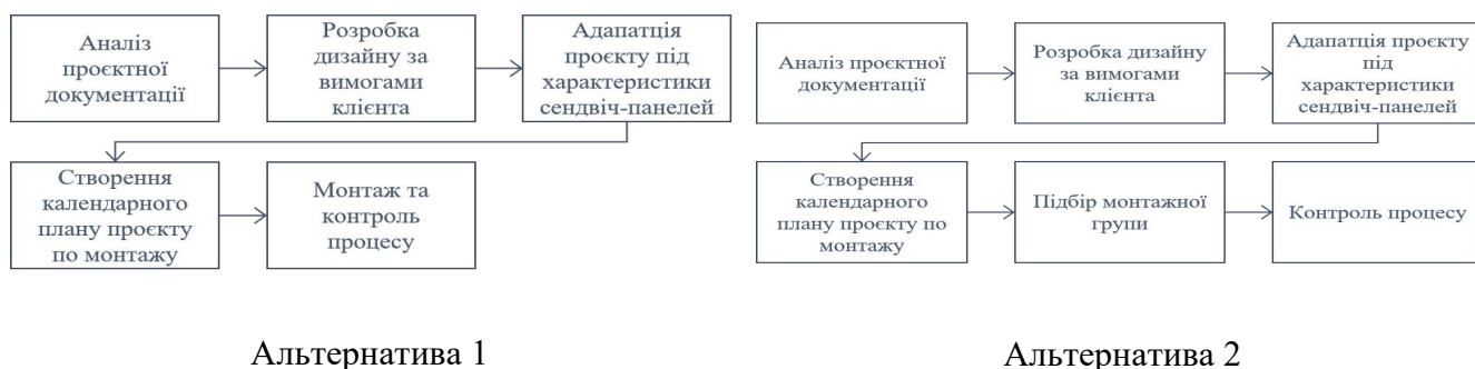
Рисунок 3.5 — Структура сервісу з монтажу з відображенням обох альтернатив
