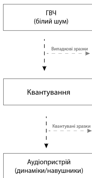
Рисунок 2.5 – Схема описаного генератора
