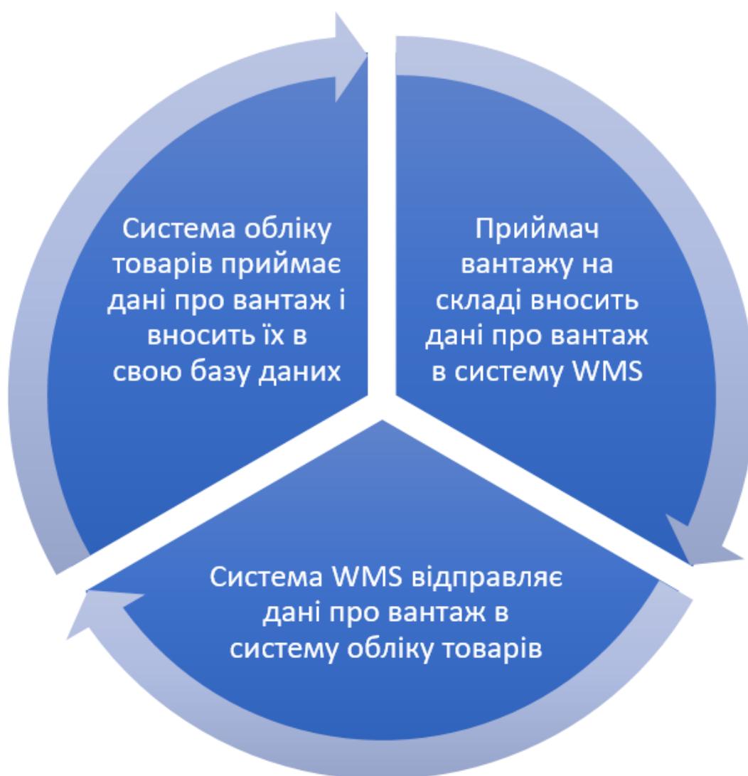
Рисунок 3.3. Алгоритм обміну даними запропонованої системи
