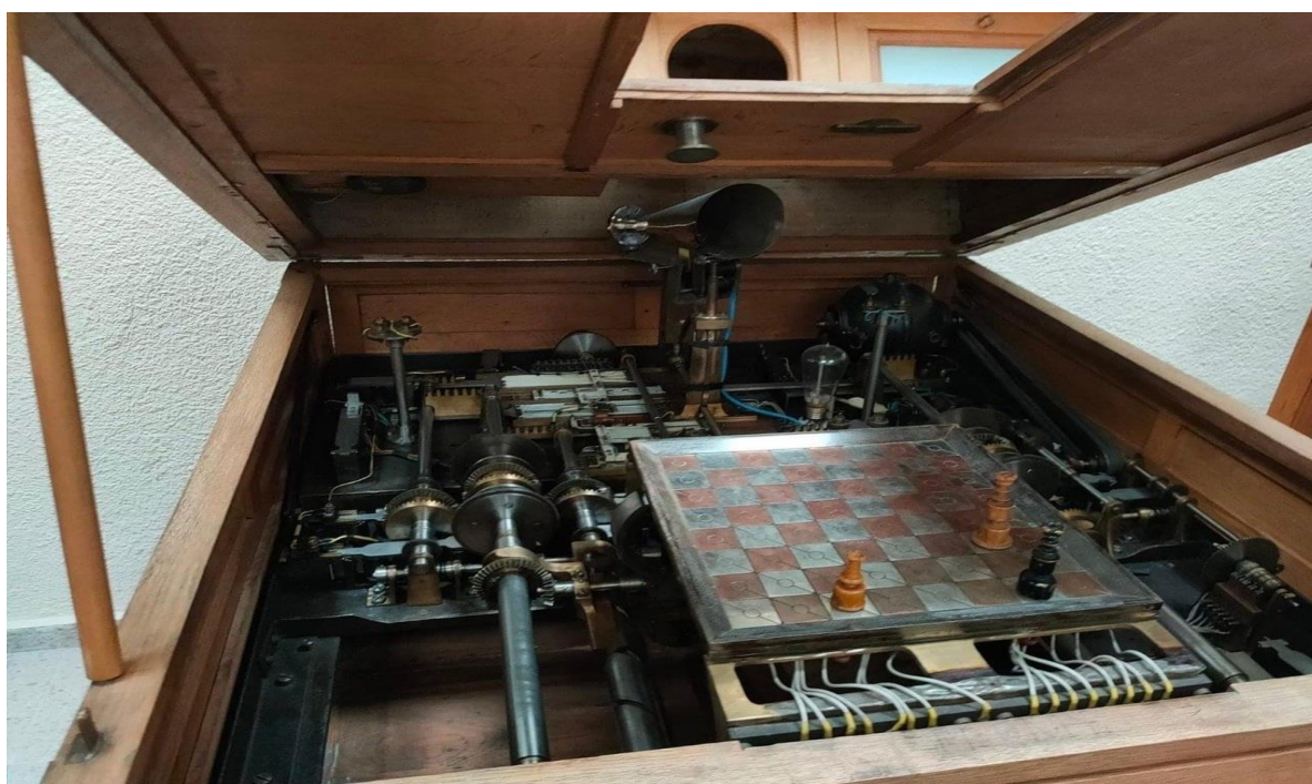
Рисунок 1.1 - El Ajedrecista - шаховий комп'ютер [Див.: 3]
