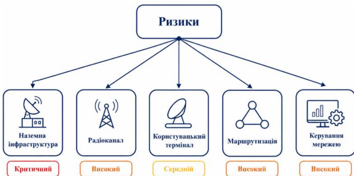
Рисунок 2.2 — Узагальнена схема ключових ризиків у LEO-супутникових мережах
