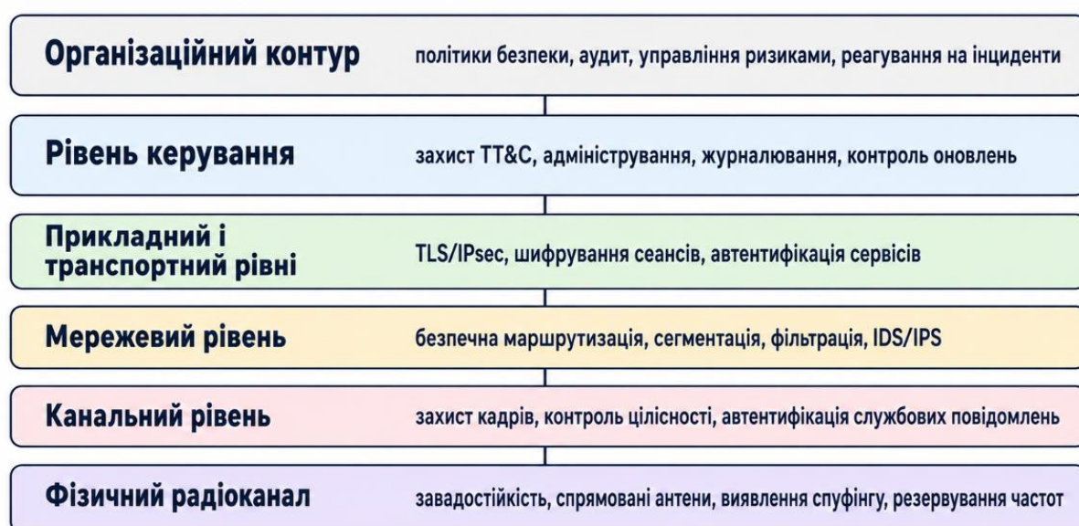
Рисунок 1.4 — Багаторівнева модель захисту передачі даних у LEO-мережі
