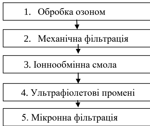
Рис. 2.2 - Технологічний процес отримання питної води ТМ "Еталон" [24]
