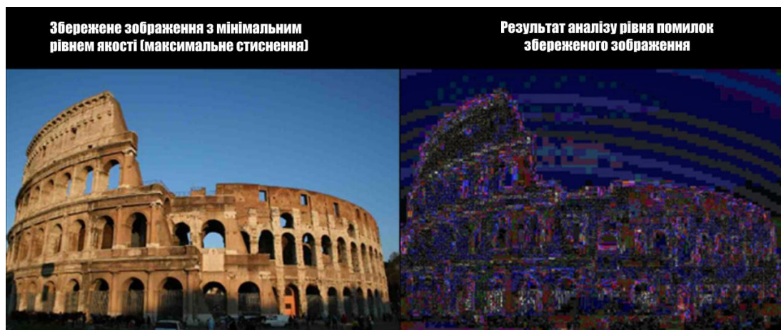
Рисунок 3.13 – Порівняння оригіналу нижчої якості з результатом ELA
