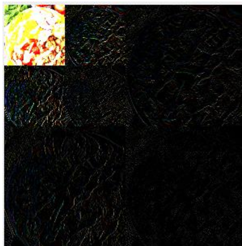
Рисунок 2.14 – Зображення, що зазнало двох кроків вейвлет перетворення.
