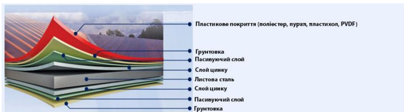
Рисунок 2.7 – Структура оцинкованого листа з покриттям. [32]
