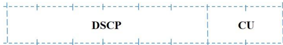
Рисунок 2.17 - Формат поля Service Type, що містить DSCP-класифікатор заголовка пакета IPv4
