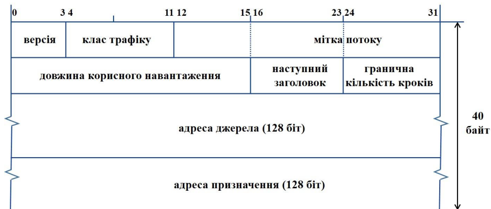
Рисунок 2.18 Формат заголовка пакетів IPv6
