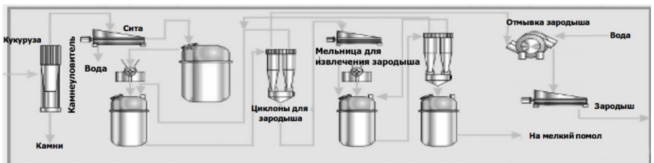
Рисунок 3.5 – Схема помелу та відділення зародку [46]
