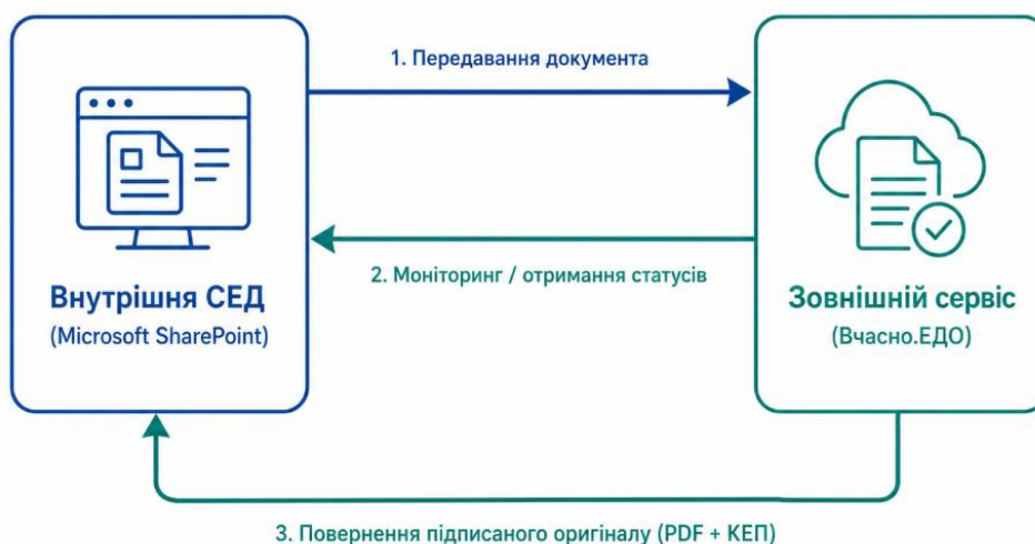
Рисунок 1.2 – Трипотокова модель передачі даних при API-інтеграції СЕД Microsoft SharePoint та зовнішнього сервісу «Вчасно.ЕДО».
