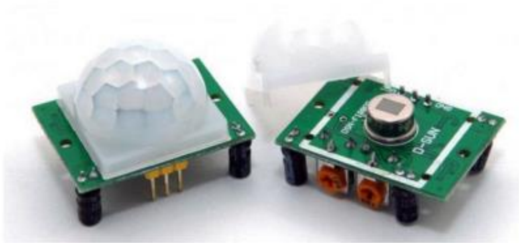
Рис. 2.11. Датчик руху HC-SR501
