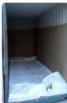
Покладений флексітанк, перед установкою щита
