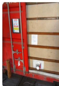
Горловина закрыта, контейнер готовый до пломбирования
