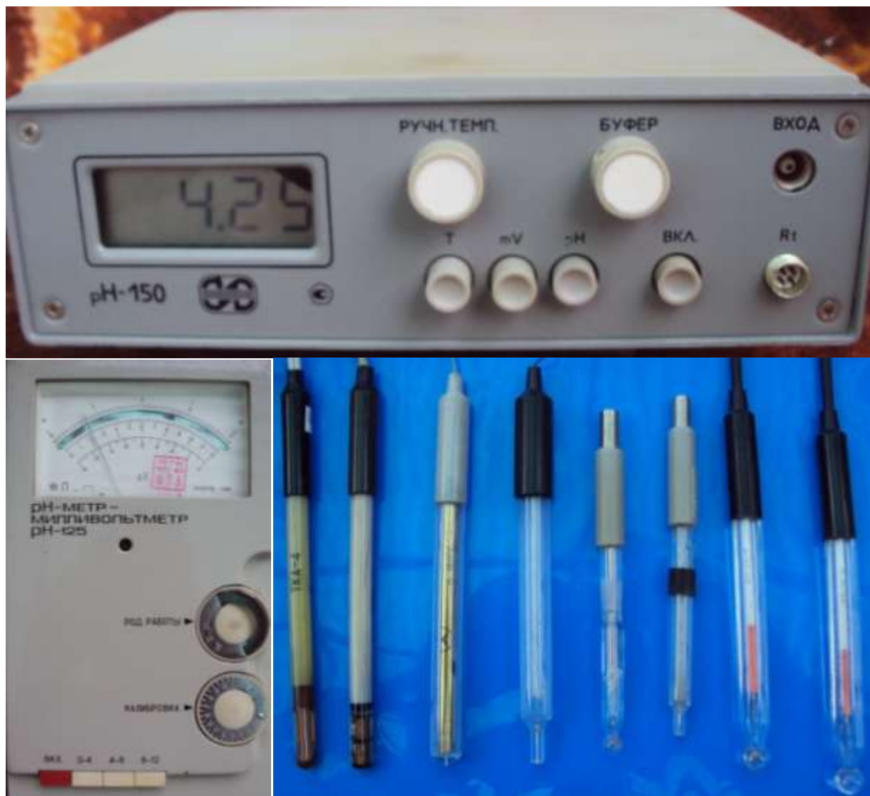
Рис. 5.2. Потенціометри для вимірювання рН (pH-150, pH-125, термокомпенсатори, електроди вимірювання та порівняння)
