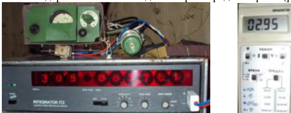
Рис. 8.1. Прилади для вимірювання та реєстрації динаміки гамма- і бета- випромінювання (ДП-5В з реєстратором, дозиметр - радіометр РСС-20.03 «Приять»)
