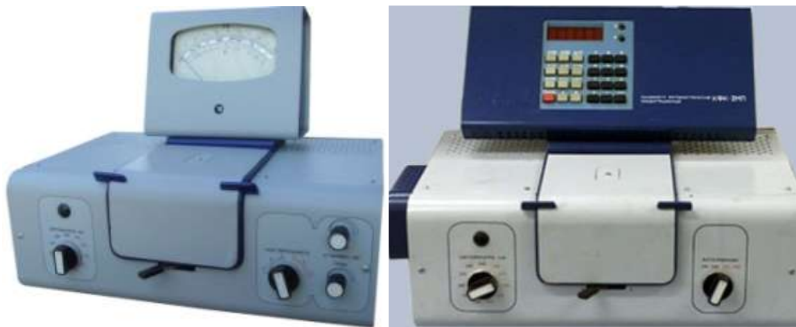
Рис. 8.4. Фотоколориметр КФК-2 (технологія відображення результатів вимірювання: зліва – аналогова; з права - цифрова)
