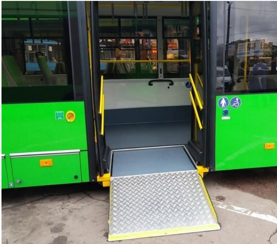
Рис. 1.2 – Низькопідлоговий автобус із відкидним пандусом для осіб з інвалідністю
