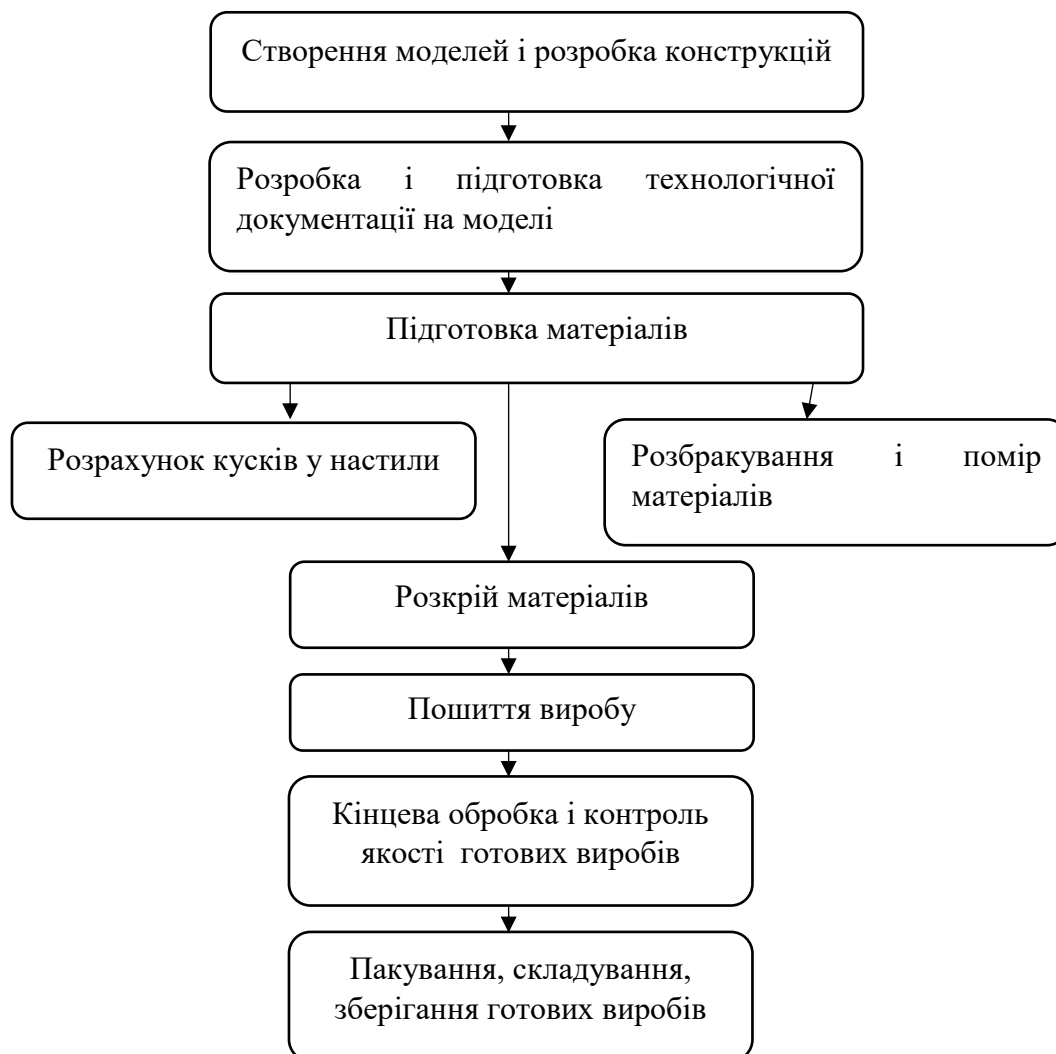
Рисунок 2.1–Принципова схема технологічного процесу, що проходить в АТ «Санта Україна»
