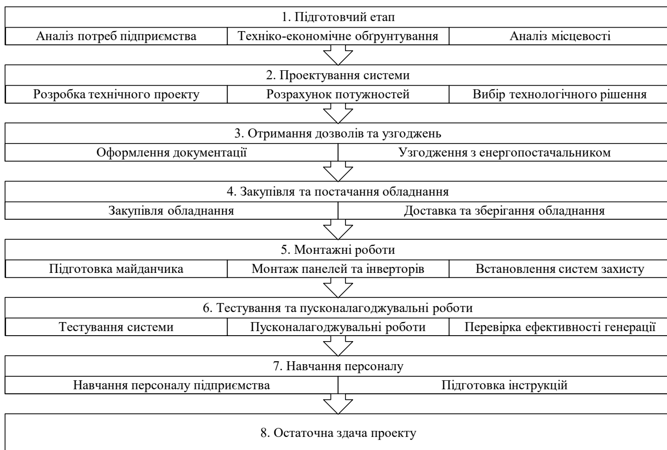
Рисунок 3.1 – Етапи впровадження сонячної електростанції для ТОВ «ВАМПАК»
