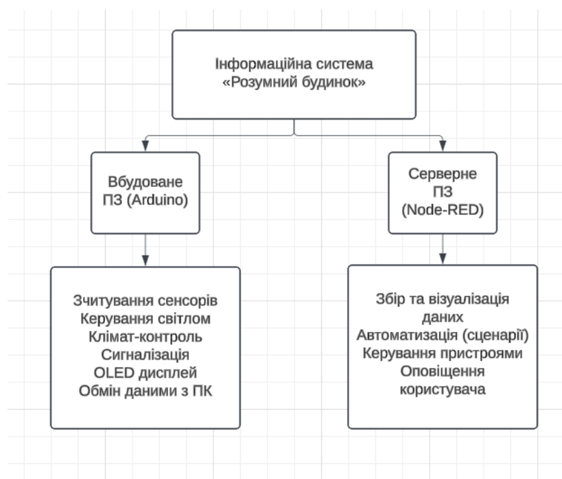
Рис. 3.15 - Структура програмного забезпечення інформаційної системи «Розумний будинок»
