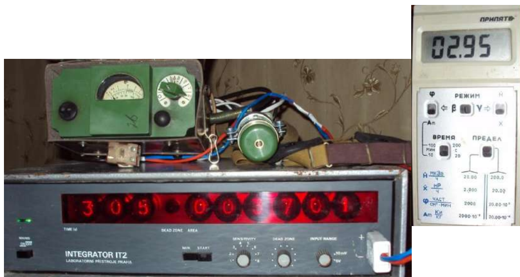
Рис. 2.12. Прилади для вимірювання та реєстрації динаміки гамма- і бета-випромінювання (ДІП-5В з реєстратором, дозиметр-радіометр РКС-20.03 «Припять»)
