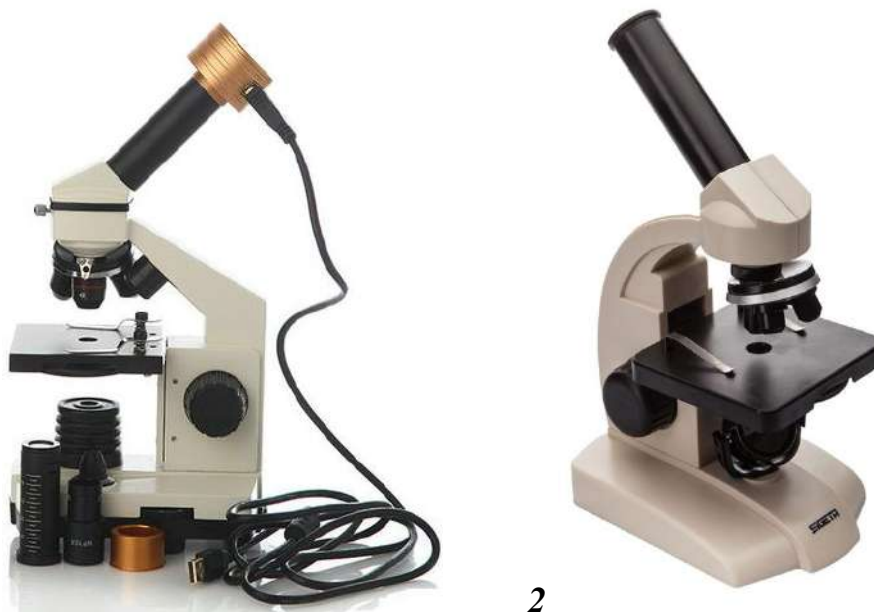
Рис. 1.3. Мікроскопи з різними функціональними можливостями: 1 – з реєстрацію зображення на комп'ютер; 2 – лабораторний мікроскоп
