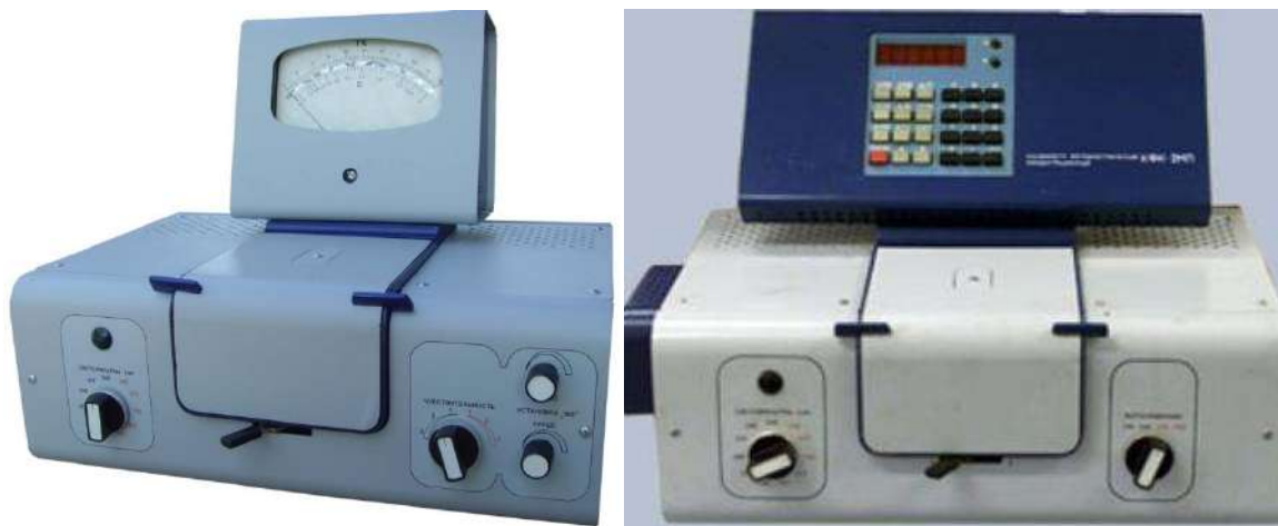
Рис. 2.15. Фотоколориметр КФК-2 (технологія відображення результатів вимірювання: зліва – аналогова; з права - цифрова)
