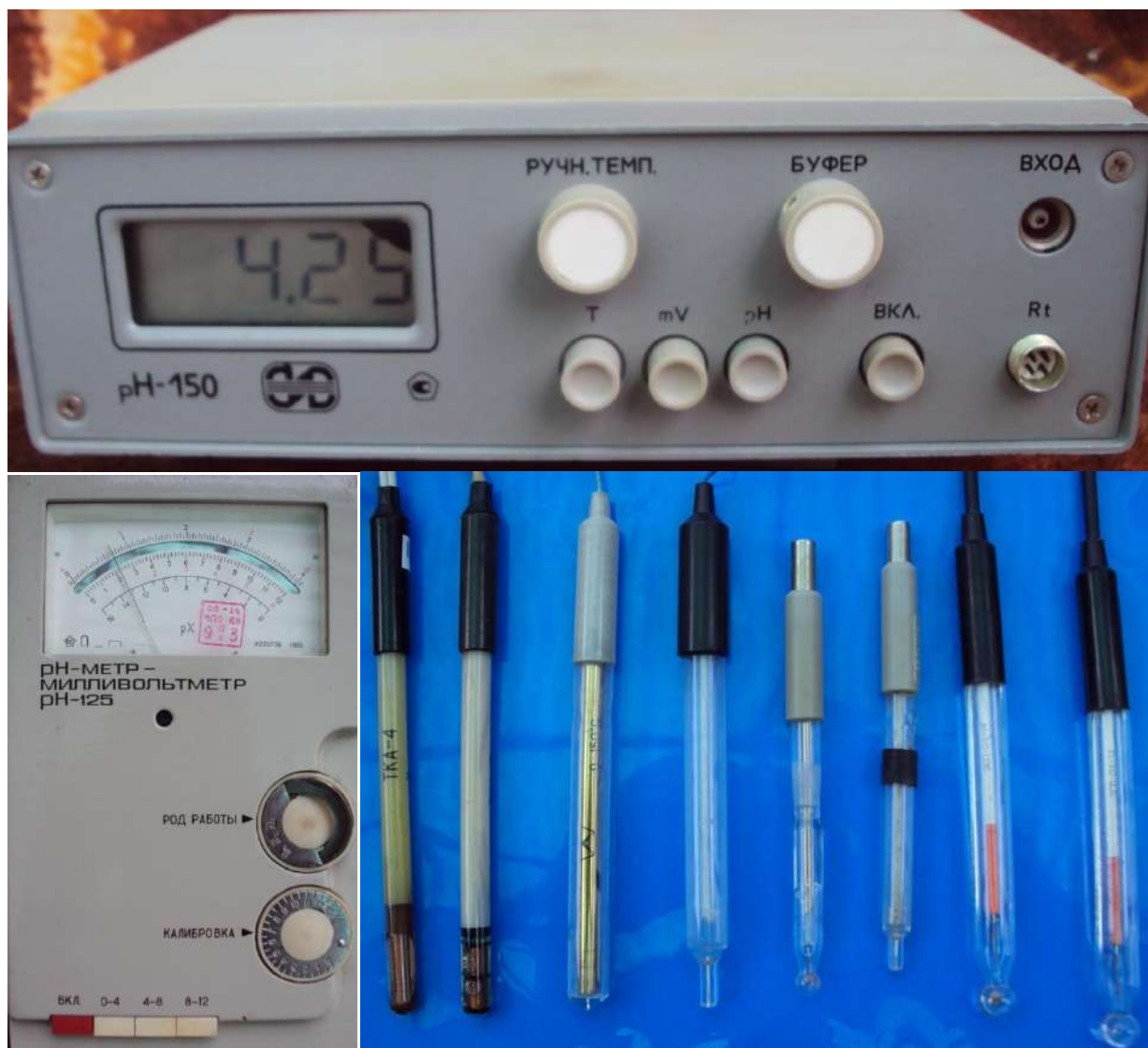
Рис. 2.6. Потенціометри для вимірювання рН (рН-150, рН-125, термокомпенсатори, електроди вимірювання та порівняння)
