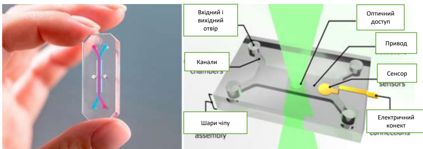
Рисунок 1.12 - Схематичний огляд компонентів мікрофлюїдного пристрою типу «орган-на-чіпі», який слід враховувати на етапі проєктування. [17]
