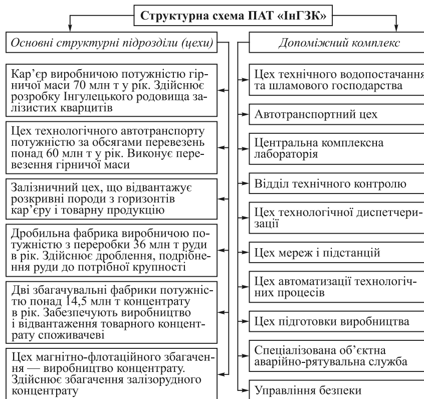
Рис. 2.1. Структурна схема виробничих підрозділів ПАТ «ІнГЗК»
