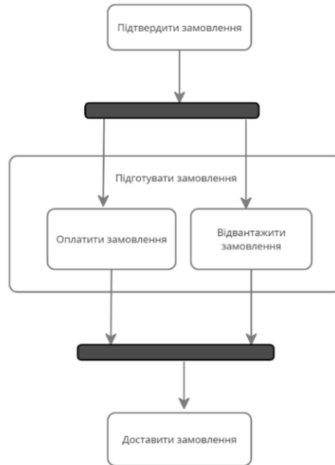
Рисунок 3.10 – Statechart diagram (діаграма станів) – послідовність станів замовлення в процесі його обробки в електронному магазині
