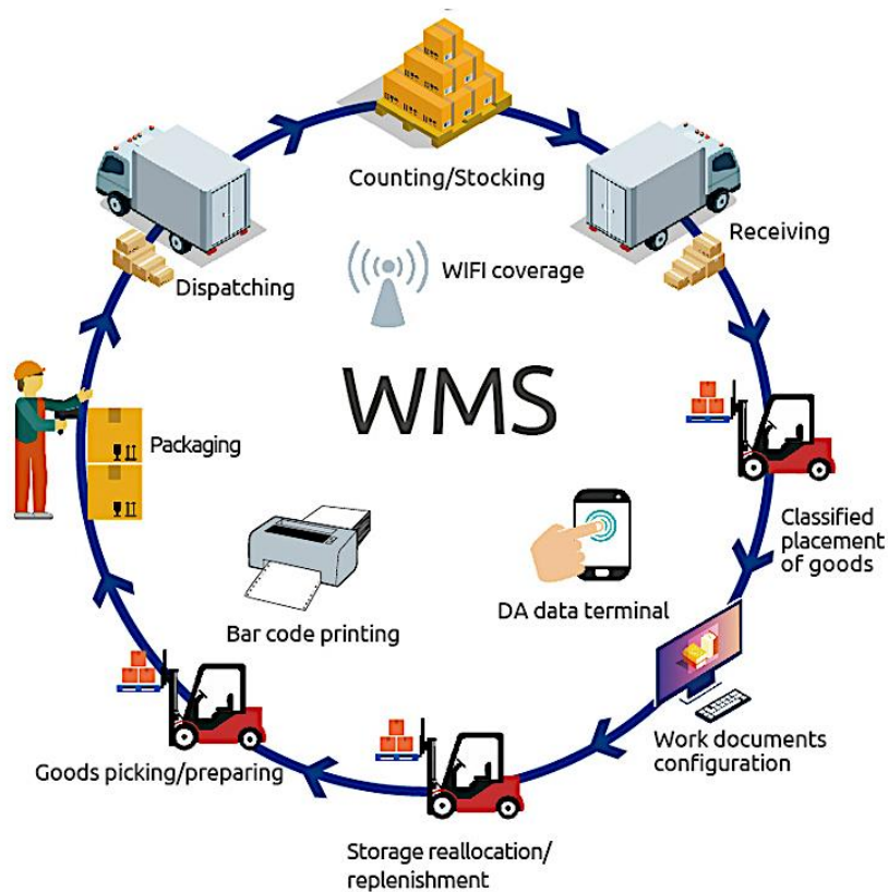
Рисунок 3.2 - Принцип роботи WMS системи [36]
