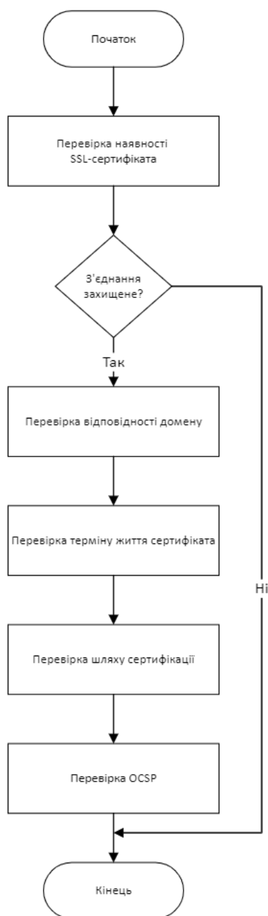
Рисунок 2.9 - Алгоритм перевірки SSL-сертифіката
