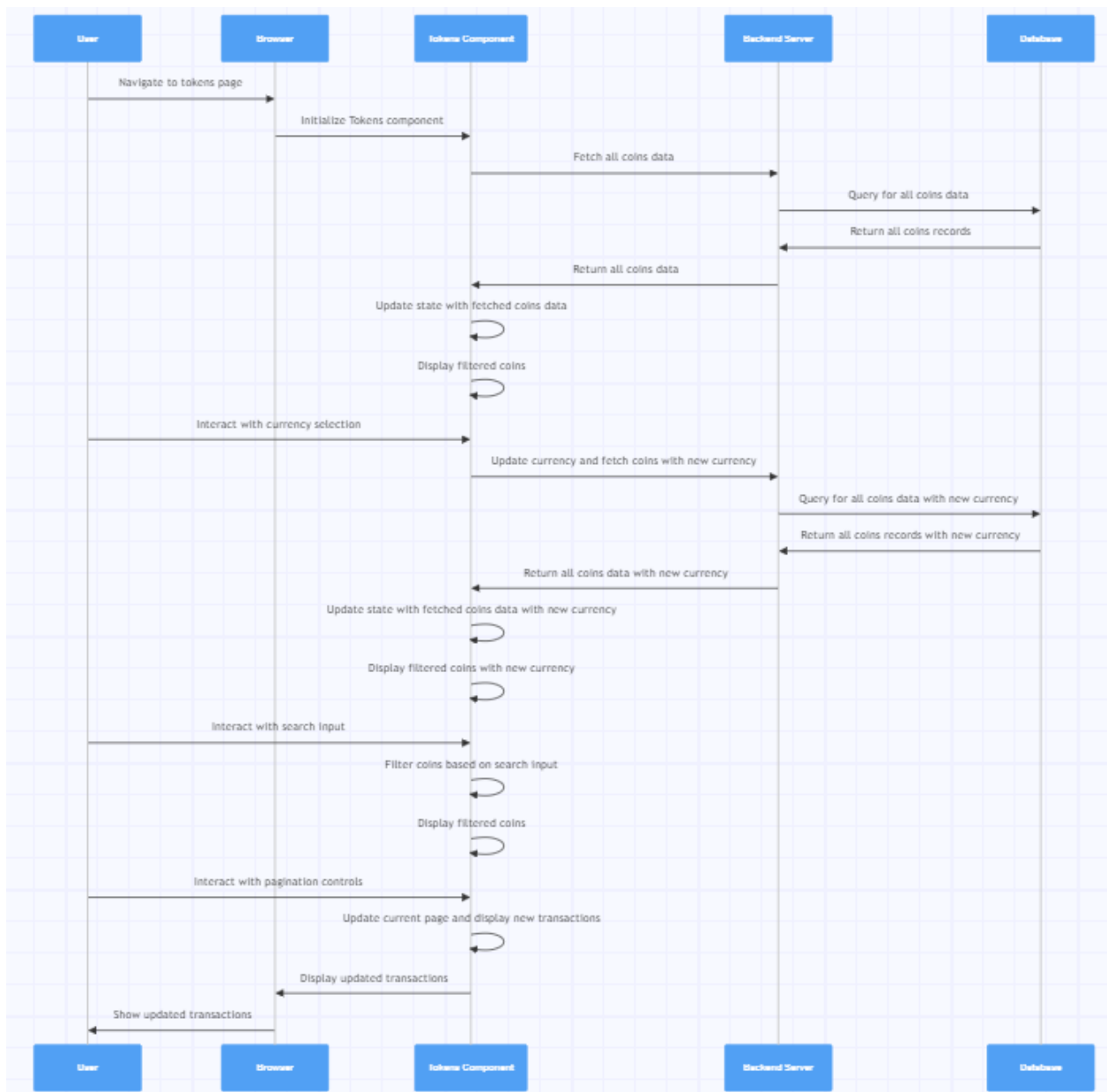
Рисунок 2.9 – Діаграма послідовності (Sequence Diagram) перегляду аналітичних даних по криптовалютах
