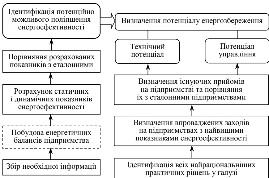
Рис. 2.11. Загальний алгоритм визначення потенціалу енергозбереження
