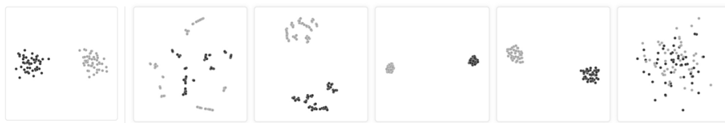
Рис. 2.6. Зміна двовимірної проекції двох кластерів випадково згенерованих точок при зміні параметру перплексії. Зліва направо: оригінальні дані, оброблені алгоритмом дані при перплексії 2, 5, 30, 50 та 100. Кількість ітерацій для всіх тестів була встановлена на 50,000.
