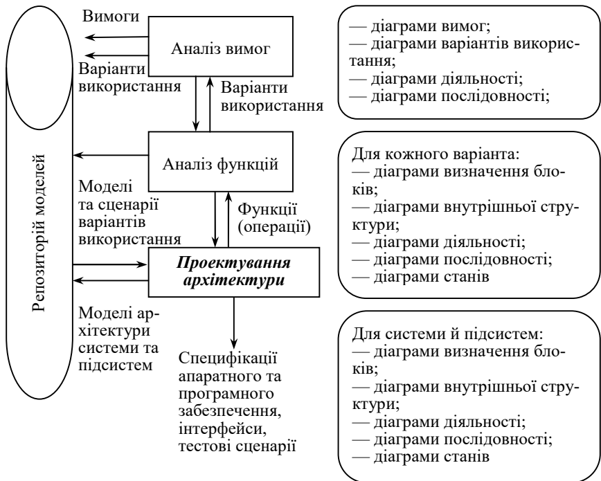
Рис. 8.2. Процес розробки систем, оснований на використанні SysML
